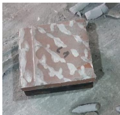
Figura 5- Ruptura na interface argamassa/placa
