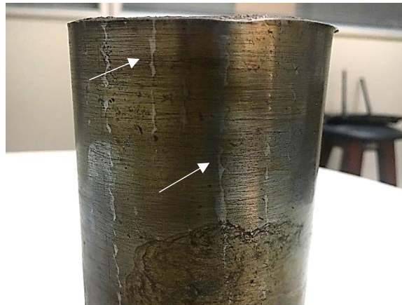
Figura 3: Vista lateral do eixo, onde as setas indicam evidências da presença de cordões de solda depositados longitudinalmente no eixo.
