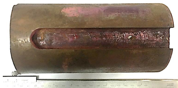
Figura 1: Segmento fraturado do eixo do motor do rotor da máquina de escavação.
