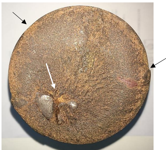
Figura 2: Macrografia da fratura do eixo, indicando morfologia de fadiga com presença de marcas de catraca, duas superfícies lisas de propagação de fadiga (setas pretas) e ruptura final (seta branca).
