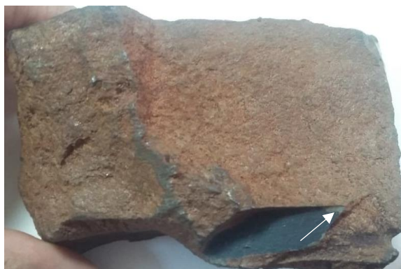
Figura 1. Planos de fratura frágil originada de sobrecarga dinâmica do componente. A seta indica o início de um dos planos da falha, onde procedemos o corte metalográfico.
