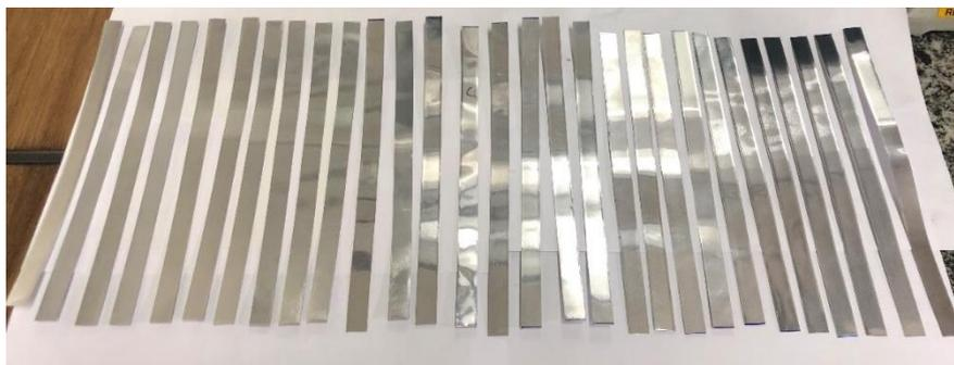
Figura 1 – Tiras da liga de alumínio para confecção dos corpos de prova 30 amostras de cada direção, conforme Norma ASTM E 345.
