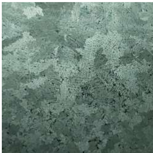
Figura III - Macrografia da peça após o ataque químico.
