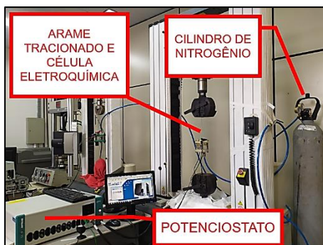
Figura 1: Sistema de teste para ensaio de fragilização por hidrogênio.
