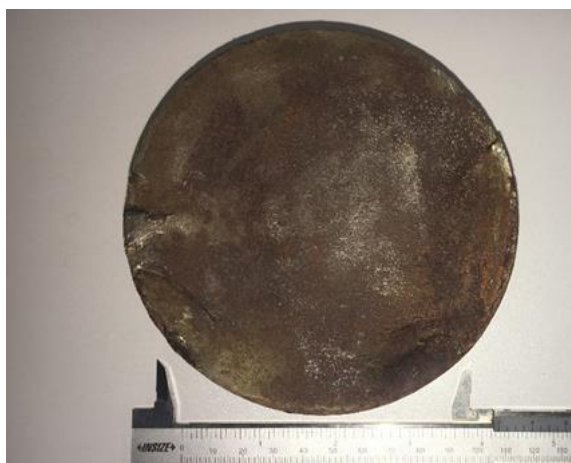
Figura 1: Superfície de fratura do eixo.
