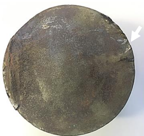
Figura 2: Macrografia da fratura do eixo, indicando morfologia de fadiga por flexão repetida. A seta indica o lugar onde nucleou a falha.
