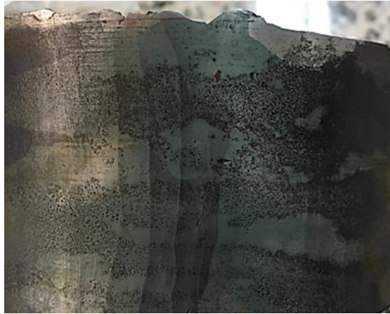
Figura 3: Vista lateral da região de início da fratura, onde observam-se evidências de descontinuidade longitudinal na superfície do eixo.
