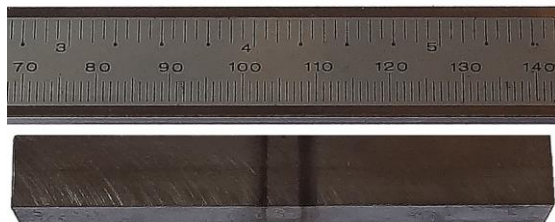
Figura 1. Corpo de prova simulado com dimensões de 10 mm × 10 mm × 71 mm apresentando a zona IC CGHAZ que está localizada na parte central da amostra com uma largura de aproximadamente 8 mm.
