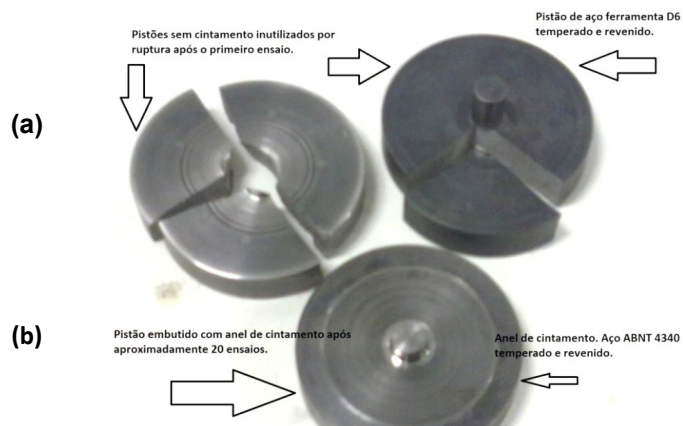
Figura 3 – Câmara fabricada: (a) Sem cintamento; (b) Com cintamento.
