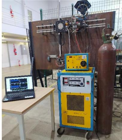
Figura 2: Bancada utilizada para a soldagem dos passes (trocar figura)
