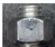
Figura 2. Comando C90. Macho desgastado. CDP Al. a) Passe único: porca M10x1,5 mm não acoplou. b) Cinco passes: porca acoplou.
