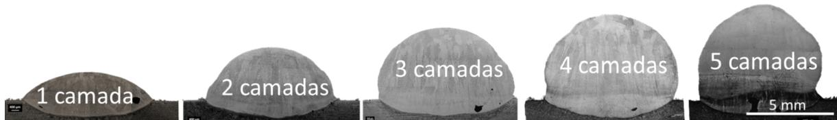
Figura 5: Seções transversais de camadas depositadas com o auxílio do dispositivo de alinhamento a laser.
