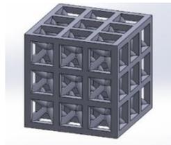
Figura 1: projeto da estrutura treliçada desenvolvida em CAD.
