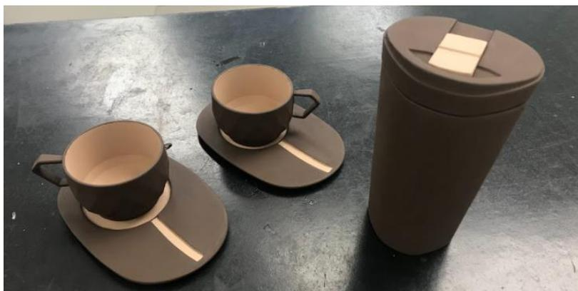
Figura 3 – Protótipo de utensílios para cafeteria utilizando filamento de PLA com borra de café. O protótipo utilizou acabamento em PVA.
