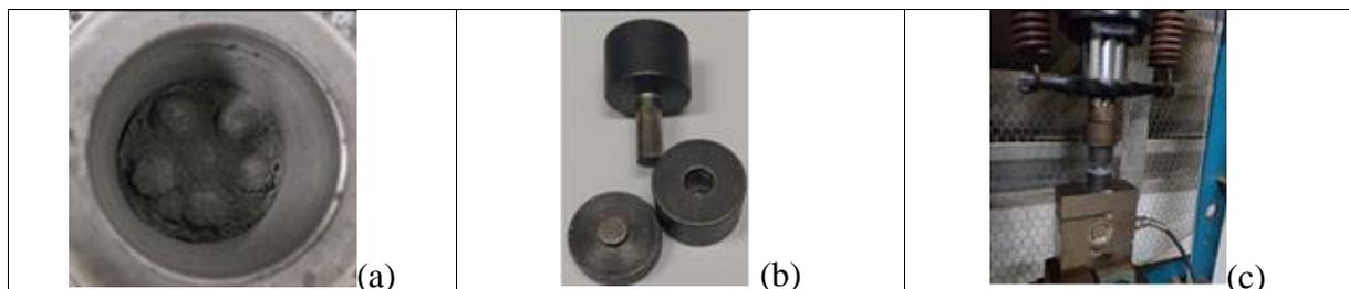
Figura 1: (a) Amostra após 1 hora de moagem com 6% de WC-17Co; (b) Matriz de compactação; (c) Prensa hidráulica do Departamento de Física (UFRN), respectivamente.
