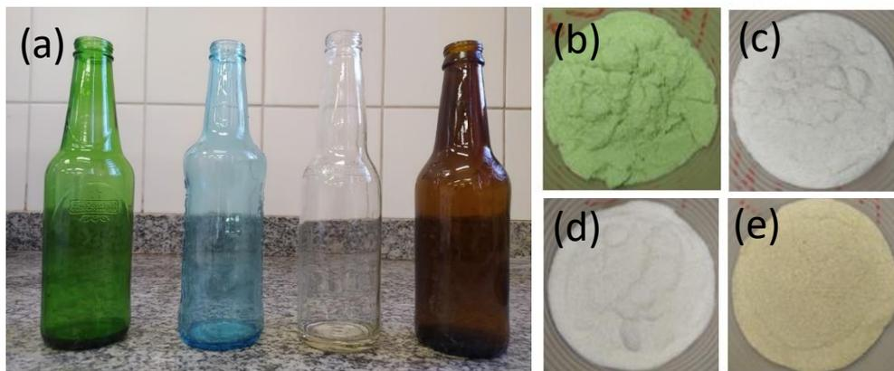
Figura 1: (a) Garrafas utilizadas para avaliar o efeito da coloração das microesferas na retrorefletividade; pó das garrafas após a etapa de moagem para as cores (b) verde, (c) azul, (d) incolor e (e) marrom.
