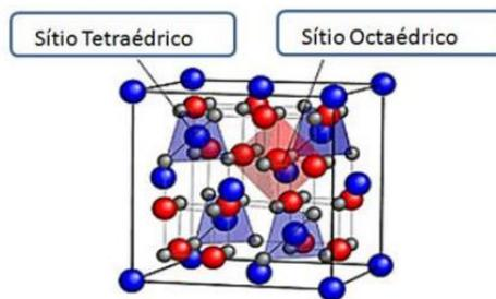
Figura 1: Sítios tetraédricos (azul) e sítios octaédricos (vermelho) de uma estrutura espinélio. As esferas cinzas representam os átomos de oxigênio da estrutura.
